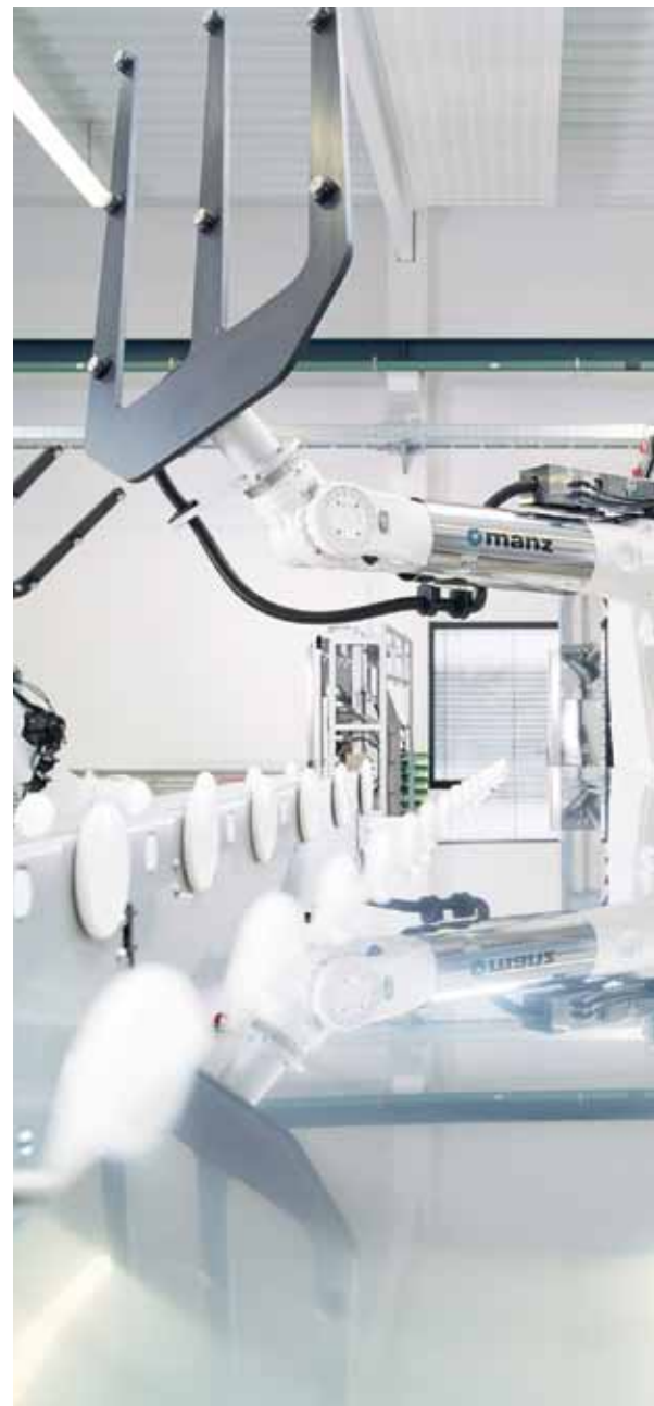
Manz-Automatisierungssystem für die Handhabung von FPD-Glassubstraten
