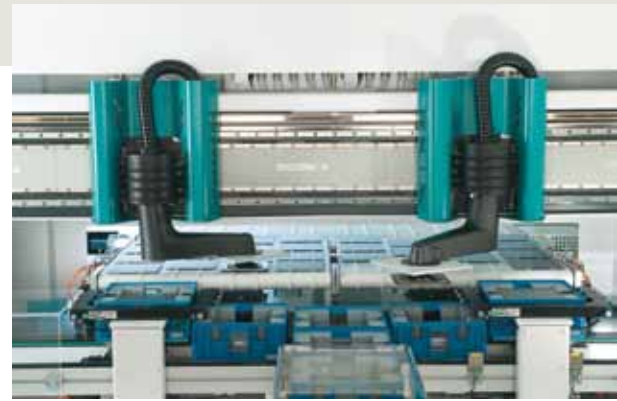
Speedpicker-Automationsanlagen ermöglichen einen hohen Durchsatz kristalliner Zellen bei minimalen Bruchraten
