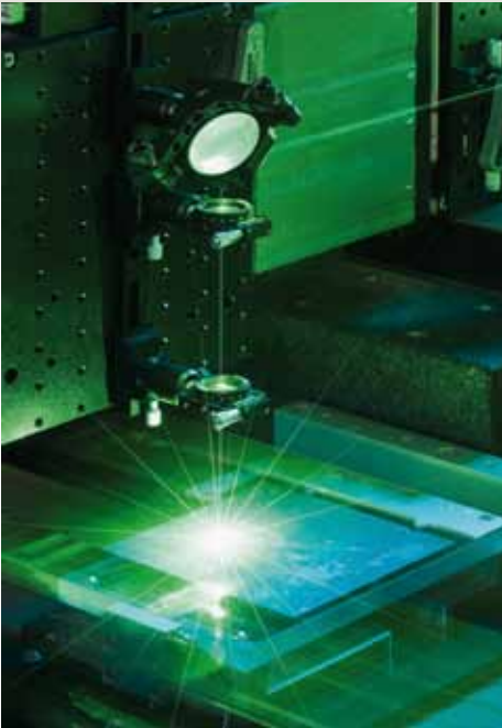
Das „OneStep Selective Emitter-Verfahren“ per spezieller Laseroptik erhöht den Wirkungsgrad von Solarzellen
